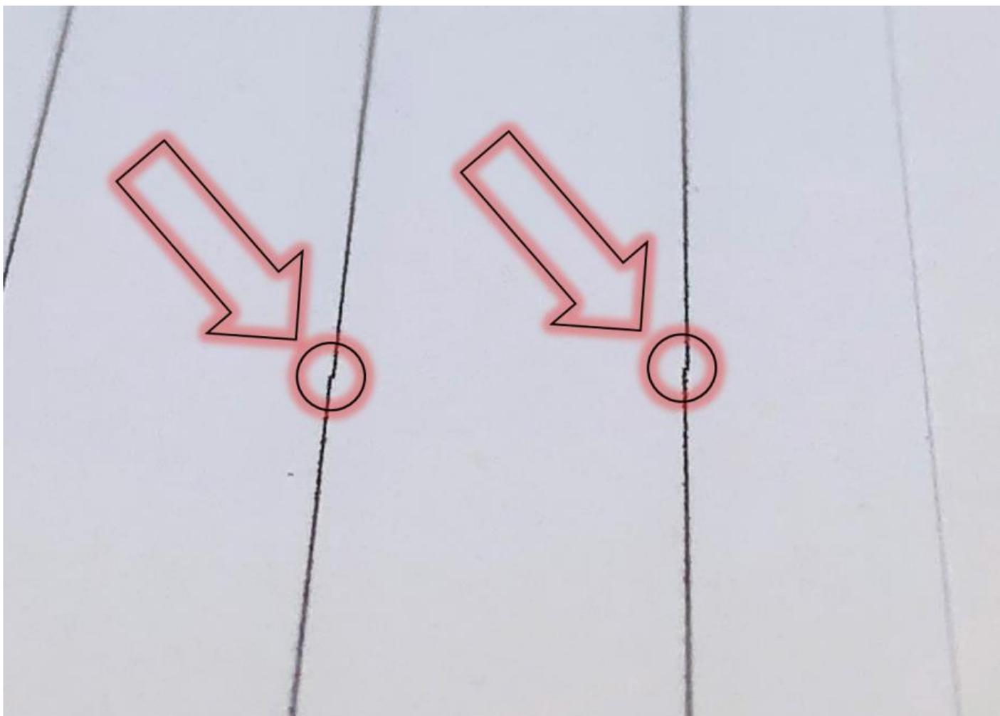
まっすぐなはずの先が、途中でズレていたり、文字がぼやける場合、まずは「**ヘッドの位置調整**」を行ってみてください。インクジェットプリンターの「ヘッド」は、印刷時に忙しく左右に動きます。また、インクカートリッジの交換や、設置場所を変えたりする際の振動で、ヘッドの位置がズレてしまうことがあります。
